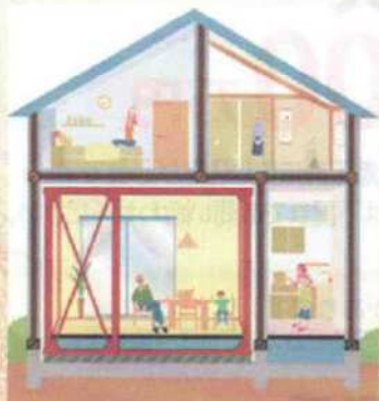
耐震シェルター（一例）
